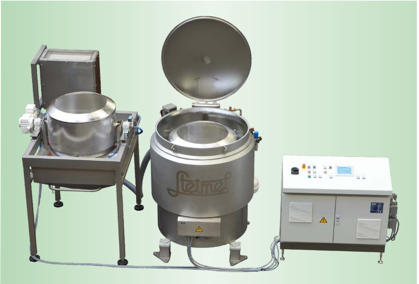
SCHOKO-POLAR 8 Zentrifuge (Bild Mitte) mit optionaler Entleerstation (Bild links, Vordergrund), optionaler Zuluftfilterung Stufe 9 (Bild links, Hintergrund) und Steuerung (Bild rechts).
